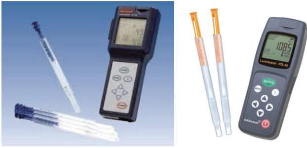
照片3 ATP荧光检测用的检测设备。左边的照片是当初使用的早期型号“PD-10”，右边的照片是最新型号“PD-30”（两款都由龟甲万百欧凯米发株式会社制造）（备注：“PD-10”现在已经停止发售）
