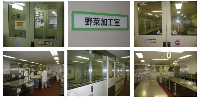
照片2 按不同的流程划分工作室。根据清洁度不同，划分为3等级：清洁区、轻微污染区及污染区，在各个房间门上的金属板上用不同的颜色区分这些工作区域。
