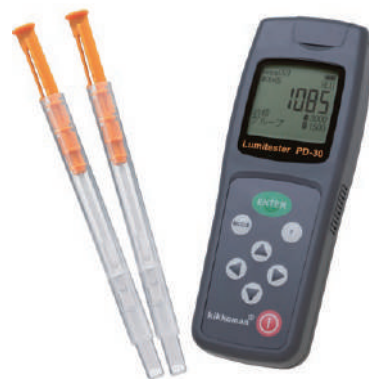
用于ATP检测的荧光检测仪“PD-30”和指定试剂“LuciPac Pen”(龟甲万百欧凯米发株式会社)
