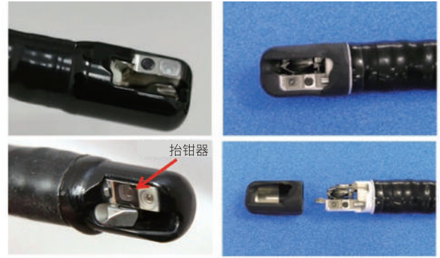
【美国】先端部拥有拾钳器。结构复杂,如果未彻底清洗、消毒,便很可能造成微生物残留。 【日本】具有可拆卸的先端帽,可刷洗。较美国的十二指肠内窥镜更易清洗。
