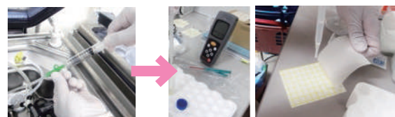
照片3 对冲洗法回收到的液体进行A3法和微生物检测
