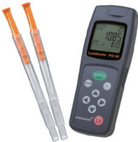
照片3 便携式ATP荧光检测仪 Lumitester“PD-30”和试剂“LuciPac Pen” Kikkoman Biochemifa Company 生产
