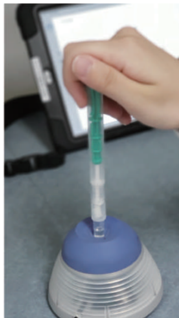
照片1 用涡旋混匀器搅拌试剂15秒
