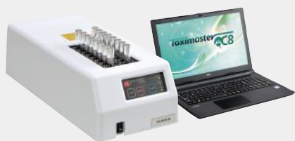
图2. 专用检测仪Toxinometer®
